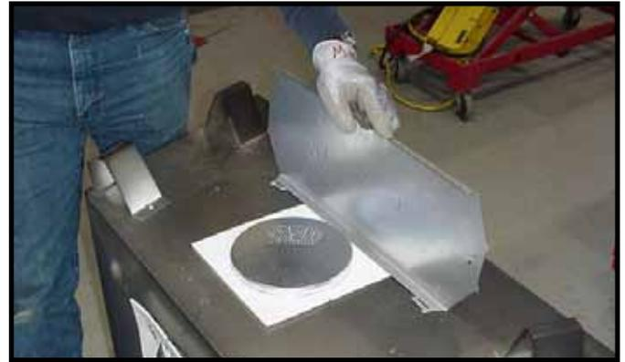
Figura 17. Levante el escudo térmico y posicónelo verticalmente como se muestra en la figura 7.2. El escudo térmico debe permanecer posicionado verticalmente.
