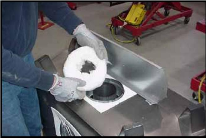
Figura 21. Retire el aislamiento del collarín exterior.
