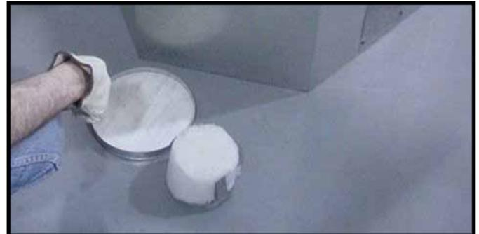
Figura 26. Deseche la tapa selladora y el retenedor de aislamiento. Nota: Una vez de que se haya retirado la tapa selladora, ésta no se puede volver a instalar.
