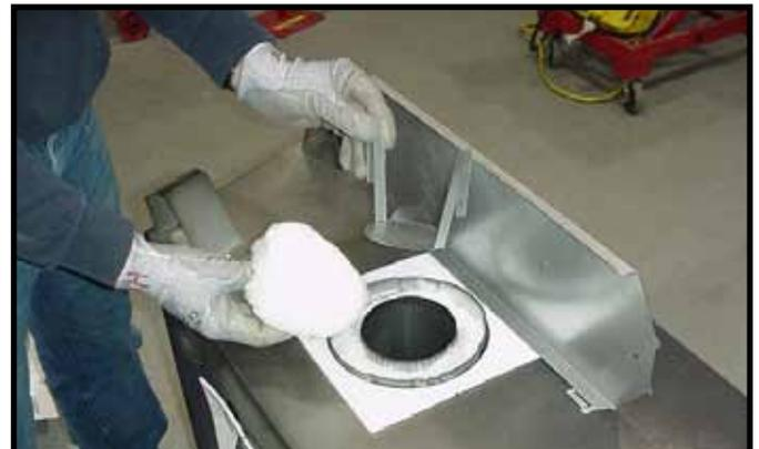
Figura 20. Retire el retenedor de aislamiento y el aislamiento que se encuentra dentro del tubo central.
