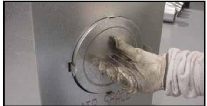
Figura 25. Jale la banda retenedora hacia afuera para así retirar la tapa selladora.
