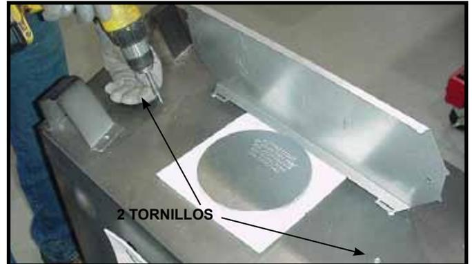
Figura 18. Vuelva a colocar los tornillos como se muestra.
