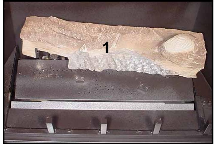
**TRONCO N° 1 (SRV327-701):** Coloque el tronco N° 1 en la parte trasera de la unidad con el borde izquierdo detrás de la lengüeta del soporte del piloto. El extremo derecho debe estar detrás de la lengüeta del soporte de sujeción.
