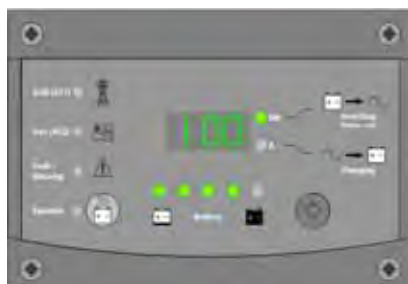
Figura 2-19 Comprobación de voltaje de CA
