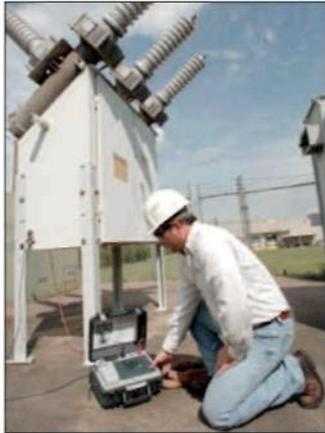
**El probador de resistencia de aislamiento S1-552 en uso en una subestación de un complejo industrial**
