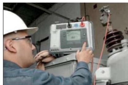
**Interrupción automática probado con el probador de resistencia de aislamiento S1-552**
