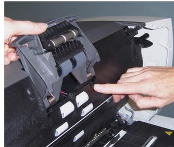
6. Presione hasta que el módulo del separador encaje en su sitio.
