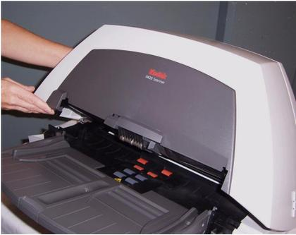
3. Tire hacia arriba para abrir la cubierta del scanner.
