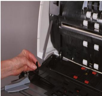
NOTA: Es posible que necesite levantar la bandeja de entrada ligeramente para extraer la cubierta del rodillo delantero.
