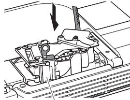
Asegúrese de que las ranuras del cartucho de lámpara se alineen con las ranuras del alojamiento de lámpara.
