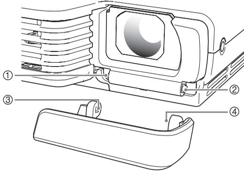
2. Manteniendo la protuberancia izquierda (③) en la depresión izquierda (①), presione suavemente la cubierta del objetivo hacia la derecha a medida que inserta la protuberancia (④) de la lengüeta de la cubierta del objetivo derecha, en la depresión (②) de la lengüeta derecha debajo del objetivo.
