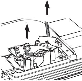
7. Coloque el cartucho de lámpara nuevo en toda su extensión posible, como se muestra en la ilustración.
