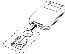
3. Vuelva a colocar el portapila dentro del controlador remoto.
