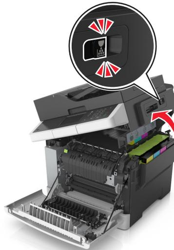
3 Extraiga el cartucho de tóner levantando las palancas y, a continuación, tirando suavemente del kit de imagen.
