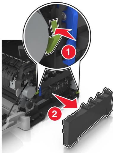
6 Levante las palancas azules de la unidad de imagen y tire después de la unidad de imagen hasta que se detenga.
