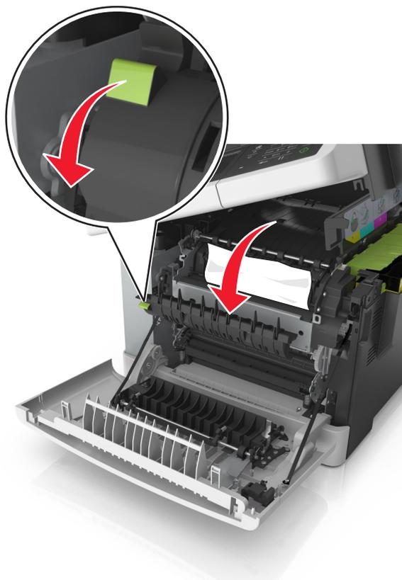
4 Sujete abajo la cubierta del fusor y retire el papel atascado.
