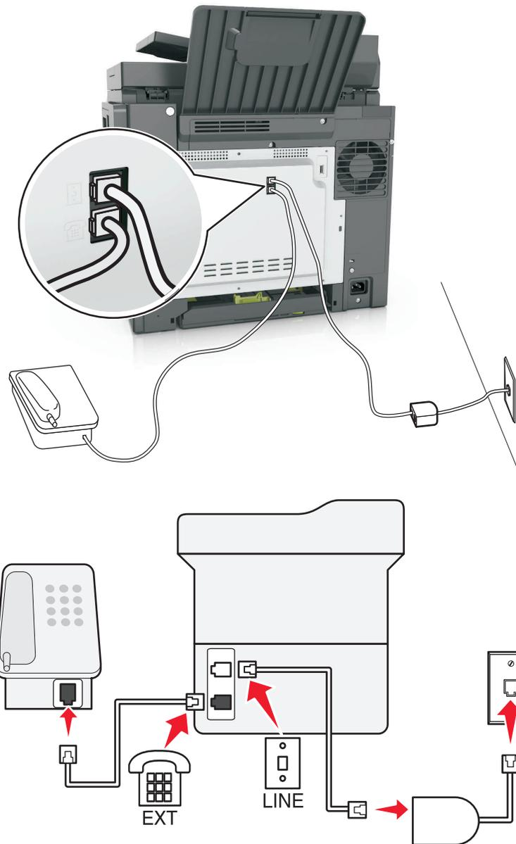
Una línea digital de abonado divide la línea de teléfono habitual en dos canales: voz e Internet. Las señales de teléfono y fax viajan a través del canal de voz mientras que la señal de Internet transcurre por el otro canal. De esta forma, puede utilizar la misma línea para llamadas de voz analógicas (incluido el fax) y para el acceso digital a Internet.
