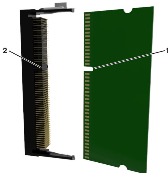
4 Introduzca la tarjeta de memoria en el conector y, a continuación, empuje la tarjeta hacia la placa controladora hasta que *encaje* en su lugar.
