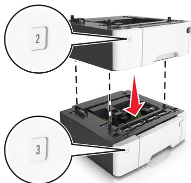
4 Alinee la impresora con la bandeja dúplex de 650 hojas y baje la impresora hasta que encaje.
