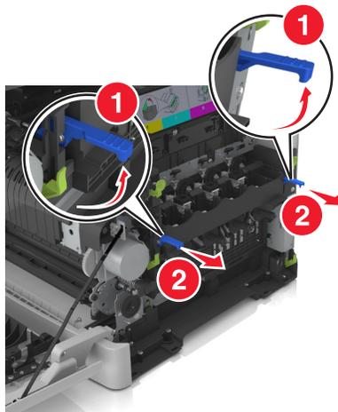
7 Presione la palanca azul y sujete las asa verdes de los laterales para extraer la unidad de imagen.
