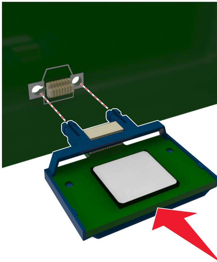
**Advertencia—Posibles daños:** La instalación inadecuada de la tarjeta podría provocar daños en la tarjeta y en la placa del controlador.
