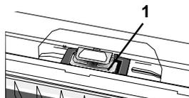
3 Si va a cambiar la cinta: levante la parte delantera del cartucho, sáquelo de la cabeza de impresión y descártelo.
