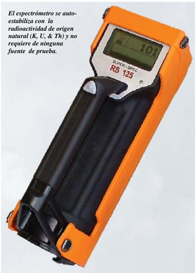
*El espectrómetro se auto-estabiliza con la radioactividad de origen natural (K, U, & Th) y no requiere de ninguna fuente de prueba.*
