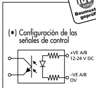
(\*) Configuración de las señales de control
