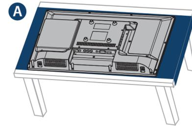
**B** Su televisor tiene cuatro agujeros de montaje VESA en la parte posterior. Si fija un soporte de montaje en pared a la parte posterior de su televisor, el soporte se debe fijar firmemente, utilizando los cuatro agujeros de montaje. Si usted no utiliza los cuatro agujeros de montaje, el televisor podría caerse y causar daños a la propiedad o lesiones personales. Refiérase a los documentos que vienen con su montaje en pared para las instrucciones completas de montaje.
