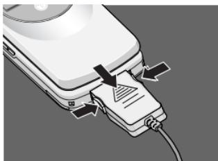
Desconecte el adaptador de viaje del teléfono pulsando sus botones laterales.
