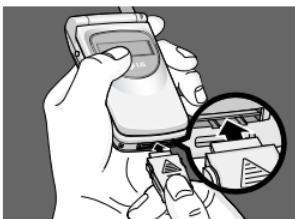
1. Inserte un lado del adaptador de viaje en la parte inferior del teléfono.
