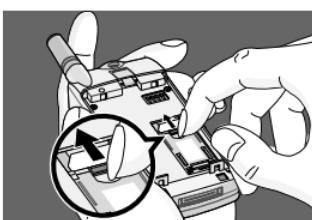
4. Cierre el soporte de la tarjeta SIM y suba el pestillo del cierre del soporte.
