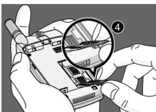
3. Deslice la tarjeta SIM dentro del soporte ④.
