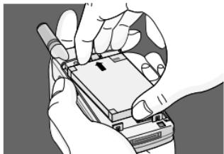
1. Sitúe el lado superior de la batería en el teléfono. (Como ilustración, véase la figura de la izquierda).
