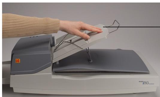
5. Tire de la patilla de extensión de la bandeja de entrada del alimentador automático hasta alcanzar la longitud deseada.
