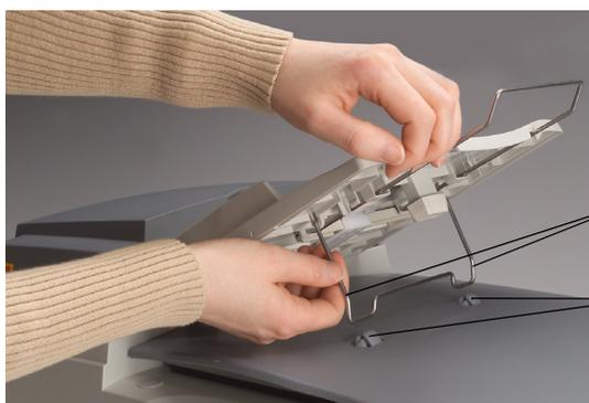
4. Presione suavemente la bandeja del alimentador automático para acoplar la patilla metálica a las pinzas.
