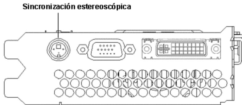
Figura 5. Acceso de salida estereoscópico Wildcat 4110 PRO
