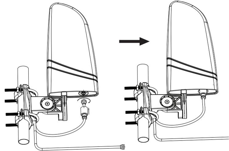
**Nota:** Si usted está usando su propio cable coaxial (por ejemplo, no el suministrado con esta antena), asegúrese de fijarlo al exterior de la base de montaje.
