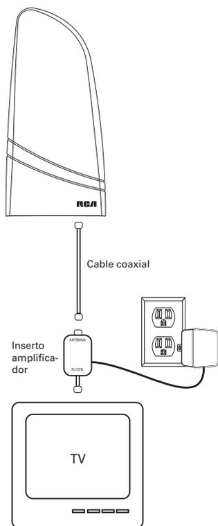
1. Corra el cable coaxial desde la antena hacia su aparato de televisión. Conecte el cable coaxial al receptáculo ANT en el inserto amplificador suministrado.
