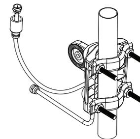
**Nota:** Si usted usó el cable coaxial provisto, asegúrese de montar la base de manera que el cable salga hacia abajo.
