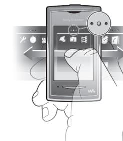
Un indicador en la parte superior de la pantalla muestra los paneles de aplicaciones en los que se encuentra. Por ejemplo, **Inicio** indica que se encuentra en el panel de aplicaciones del medio.
