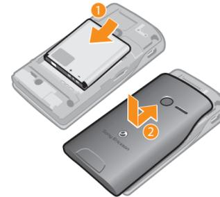
1 Inserte la batería con los conectores frente a frente.
