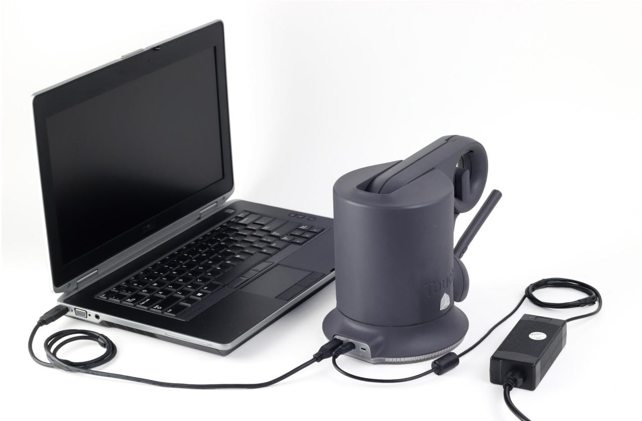
6. Asegúrese de que el **anillo LED** de la base se ilumine **de color azul**. Ese color indica que Touch dispone de corriente. Si no es así, compruebe todas las conexiones. Si el problema persiste, póngase en contacto con el servicio al cliente de 3D Systems.
