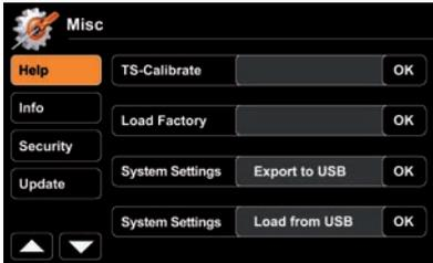
Puede exportar/importar los ajustes de su sistema a/desde una unidad flash USB. Una característica que es muy útil tras una actualización de firmware o una desconexión completa de la energía.
