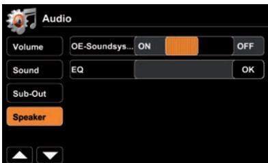
Si su vehículo ya está equipado con un sistema de sonido OE integrado, active el parámetro “Sistema de sonido OE” para evitar distorsión del sonido.
