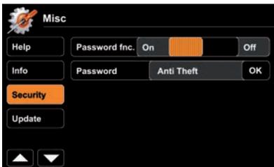
Active la función de contraseña para asegurar el dispositivo en caso de una desconexión temporal del suministro de energía (robo). Utilice un código arbitrario de 4 dígitos. Para reiniciar el código, introduzca "0000".
