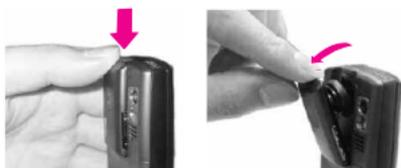
Simplemente presione el pestillo de liberación en la parte superior del teléfono y luego levante el auricular bluetooth para desconectarlo del teléfono.
