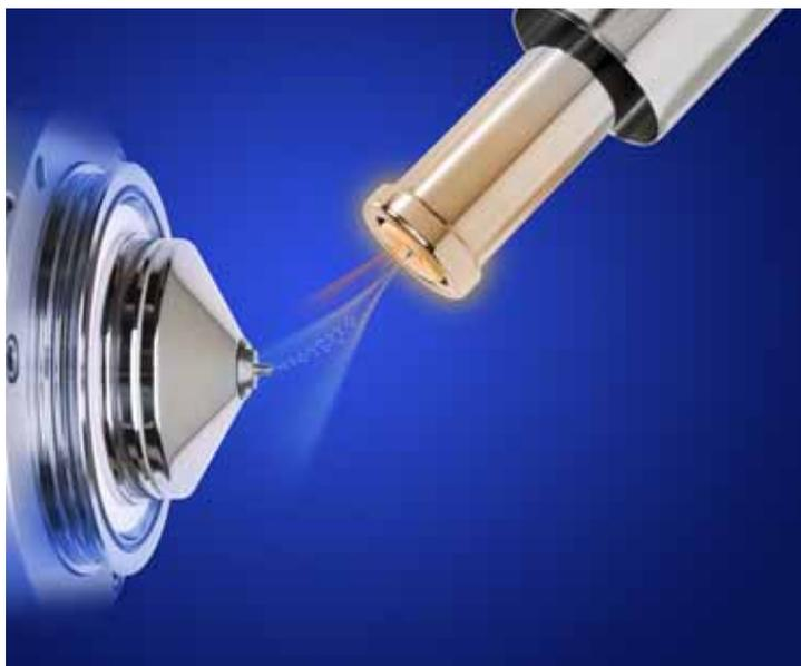
Con la ionización H-ESI, un espectrómetro de masas puede analizar una gama de pesos moleculares mayores de 100 000 u, debido a la carga múltiple. H-ESI resulta especialmente útil para el análisis de masa de componentes polares, que incluyen polímeros biológicos (por ejemplo, proteínas, péptidos, glucoproteínas y nucleótidos); farmacéuticos y sus metabolitos; y polímeros industriales (por ejemplo, glicoles de polietileno).
