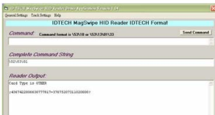
3. Si la identificación de la tarjeta aparece en la ventana Reader Output (Salida del lector), el lector está funcionando.
