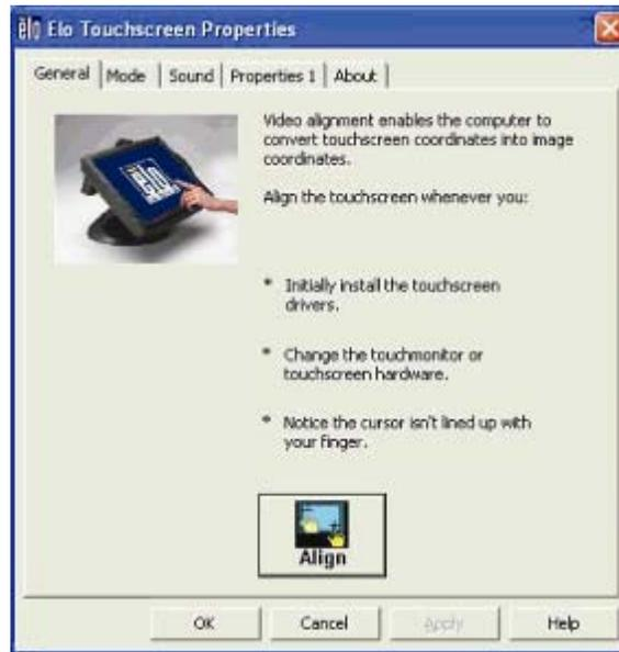
Haga clic en el botón **Align (Alinear)**. Así se ejecutará el programa de calibración. Se abrirá la ventana que se muestra a continuación. Siga las instrucciones para calibrar la pantalla táctil.
