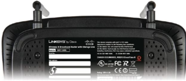
**Reinicio** El botón de reinicio está situado en la parte derecha de la etiqueta del producto. Existen dos formas de restablecer los parámetros predeterminados de fábrica del router. Pulse el botón de reinicio durante unos cinco segundos, o bien restablezca la configuración predeterminada desde la pantalla *Administration > Factory Defaults* (Administración > Parámetros predeterminados de fábrica) de la utilidad basada -en web del router.
