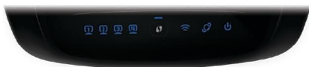
**1, 2, 3, 4** (Azul) Estas luces numeradas, que corresponden a los puertos numerados del panel posterior del router, tienen dos finalidades. Si la luz está encendida de forma continua, esto indica que el router está conectado correctamente a un dispositivo mediante dicho puerto. Si parpadea, esto indica que existe actividad de red en dicho puerto.
