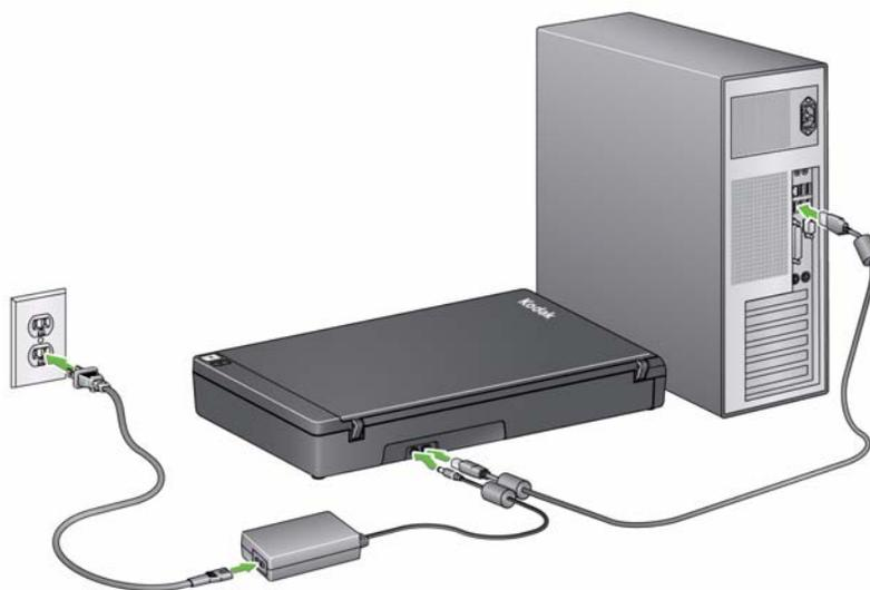
5. Conecte el otro extremo del cable USB a un puerto USB libre del equipo.
