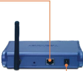
2. Conecte el adaptador de alimentación AC al Punto de Acceso y luego a una toma de corriente.
