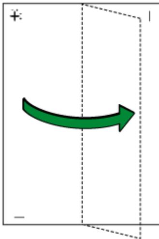
10. El valor adecuado de ajuste es la diferencia entre la línea vertical y la línea vertical de la cruz que puede ver cuando coloca el papel doblado delante de un foco de luz. Cuando la diferencia es una marca de calibración en la dirección "+", el valor adecuado de ajuste de [Dirección de impresión:] es "+1,0".
