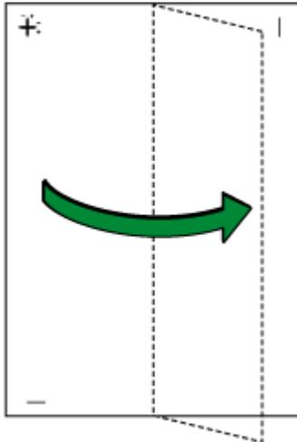
9. El valor adecuado de ajuste es la diferencia entre la línea vertical y la línea vertical de la cruz que puede ver cuando coloca el papel doblado delante de un foco de luz. Cuando la diferencia es una marca de calibración en la dirección "+", el valor adecuado de ajuste de [Direcc. lectura] es "+1,0".
