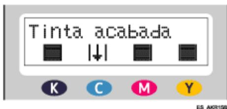
En la ilustración anterior, el panel de mandos indica que el cartucho de impresión cian está completamente vacío.
