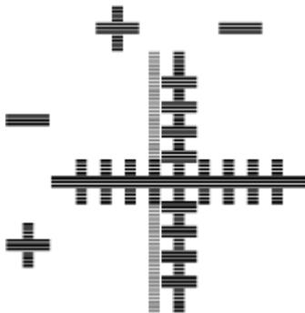
10. Doble por la mitad en horizontal la hoja con la trama de prueba y, a continuación, compruebe el valor de ajuste de [Direcc. alim.]
