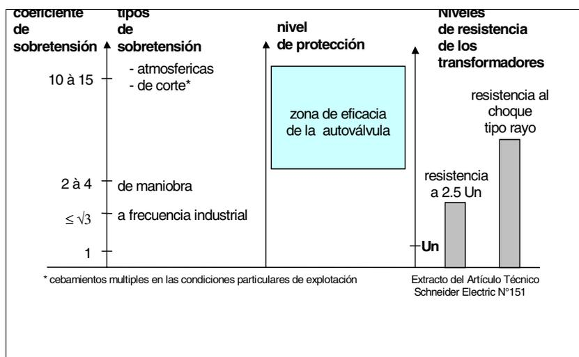
*Resistencia del transformador y las autoválvulas a las sobretensiones*
