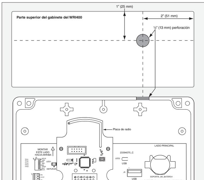
**! Para evitar dañar los componentes electrónicos en el interior del gabinete al perforar, aplique poca presión, de modo que la broca no penetre demasiado al atravesar la cubierta, o bien, quite los componentes electrónicos del interior antes de perforar.**
