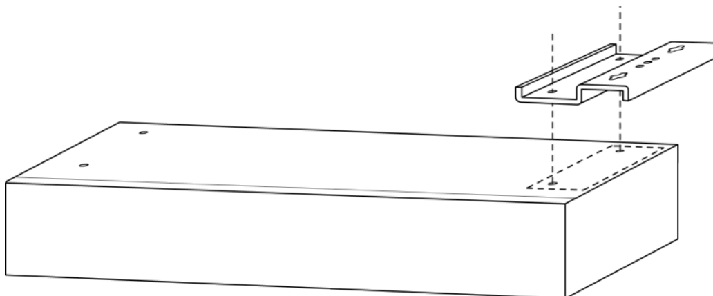
Imagen 25: colocación del montaje metálico en la parte inferior del dispositivo E3200 PSA
