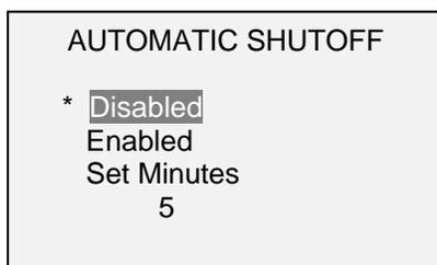
Seleccione **Disabled (Inhabilitado)** para inhabilitar el apagado automático. Seleccione **Enabled (Habilitado)** para activarlo. La duración del tiempo de inactividad se programa en minutos, a través del parámetro **Set minutes (Ajustar minutos)**. Ajustes disponibles: 5-30, en incrementos de 5 minutos.
