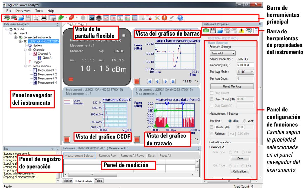
Figura 2-1 Visión general de la interfaz de usuario del Analizador de potencia
