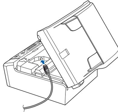
**c** Coloque con cuidado el cable USB a través de la ranura hasta que salga por la parte posterior del equipo, como se muestra a continuación, y conecte el cable al Macintosh®.
