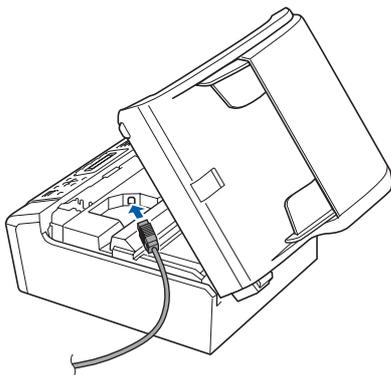
**c** Coloque con cuidado el cable USB a través de la ranura hasta que salga por la parte posterior del equipo, como se muestra a continuación, y conecte el cable al ordenador.
