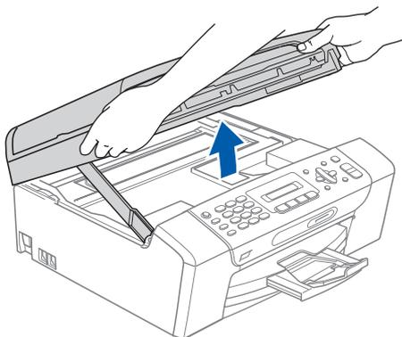
**b** Conecte el cable USB a la conexión USB marcada con el símbolo
