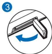
Para quitar la tarjeta, abra la cubierta (1), presione suavemente la tarjeta (2) y jale hacia afuera, luego cierre la cubierta (3).
