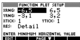
*Nota: en nuestro ejemplo, puede mantener los valores predeterminados de la configuración de trazado, ya que utilizaremos la característica Auto Scale para elegir un eje y apropiado para los valores del eje x. Si su configuración no coincide con la de este ejemplo, pulse **SHIFT CLEAR** para restaurar los valores predeterminados.*
