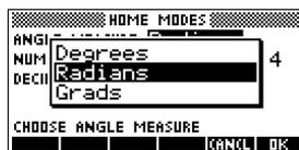
3. Pulse **[↑]** para seleccionar Degrees, y después pulse **[OK]**. La medida del ángulo cambia a grados.
