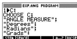
5. Cree un programa denominado EXP.S que se ejecute cuando inicie el aplet de la forma indicada. Este programa establece el modo de ángulo a grados y configura la función inicial trazada por el aplet.
