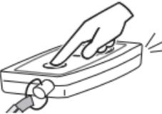
**Aviso:** Asegúrese que la potencia de la batería sea suficiente para funcionar como guardia de seguridad. Verifique periódicamente el nivel de potencia activando la sirena de seguridad.
