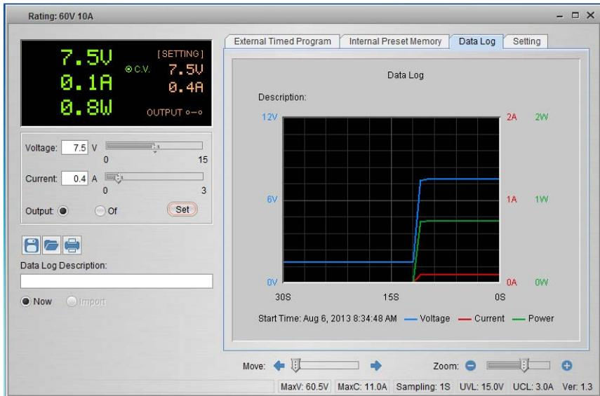
1. Ajuste el control deslizante para mover la forma de onda a la izquierda y derecha
