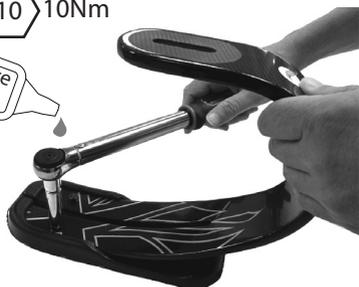
Monte la ballesta de la punta del pie en la cubierta de la ballesta del talón y apriete los pernos 10 Nm.
