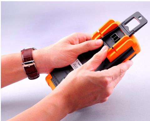
4. Vuelva a colocar la base de inclinación en posición vertical
