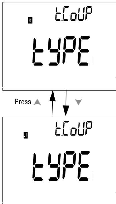
Figura 4-3 Configuración del tipo de termopar
