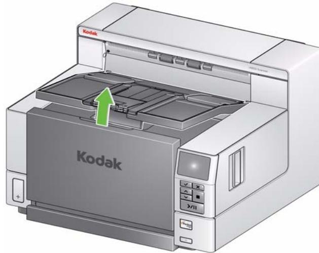
Para bajar la bandeja de salida, presione suavemente la pestaña de ajuste de altura bajo la bandeja de salida, a la vez que baja la bandeja de salida en la tapa de acceso a la impresora.
