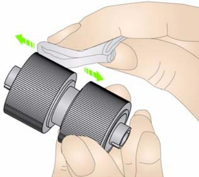
6. Inspeccione las gomas. Si muestran señales de deterioro o daños, sustituya las gomas de separación. Consulte la sección "Procedimientos de sustitución" que encontrará más adelante en este capítulo.
