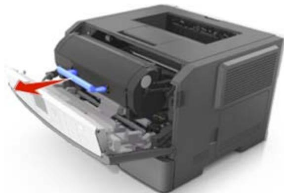
3. Levante la palanca verde y, a continuación, extraiga la unidad de imagen de la impresora.
