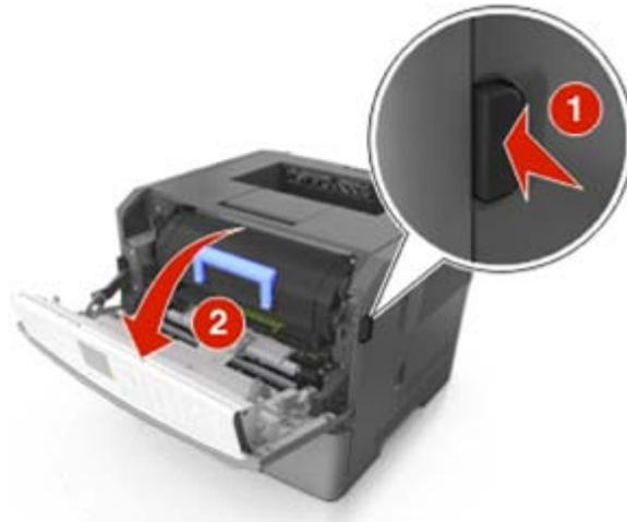
2. Extraiga el cartucho de tóner mediante la palanca.
