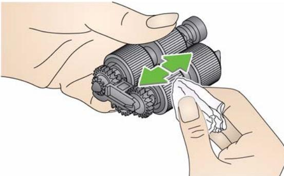
4. Inspeccione el módulo de alimentación. Si muestra señales de deterioro o daños, sustituya el módulo de alimentación o las gomas. Consulte la sección titulada, "Sustitución del módulo de alimentación y sus gomas" a continuación en este capítulo.
