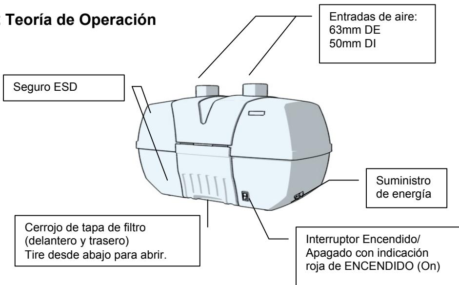
La extracción eficiente de humos peligrosos en su lugar de trabajo es un proceso que consta de dos pasos: captura y filtrado de humos. La unidad de filtrado se suministra con un juego de filtros ya instalado.
