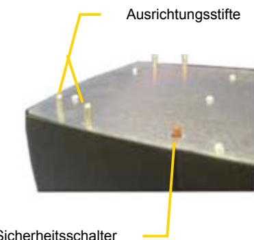
**! WARNUNG!** Die Sicherheitsverriegelung darf nicht überbrückt werden, da dies zu Personenschäden führen könnte.
