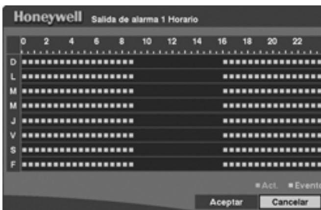
Figura 44 — Pantalla Salida de alarma Horario
