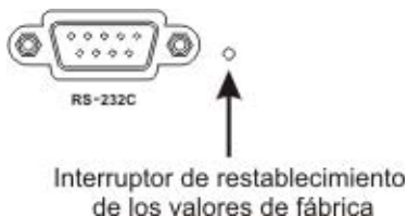
Figura 13 — Interruptor de restablecimiento de los valores de fábrica
