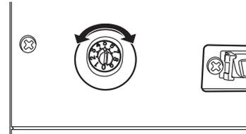
La configuración predeterminada de fábrica de la identificación de SCSI es "5". Si el número de identificación de SCSI de otro dispositivo se encuentre ya configurado con el mismo ID (5), cámbielo ya sea el del escáner o del otro dispositivo.
