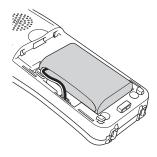
Instale la cubierta de la batería deslizándola sobre la parte trasera del teléfono inalámbrico.
