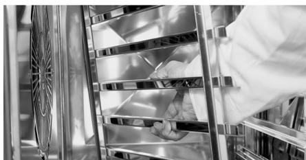
**5** Retire el bastidor de enganche izquierdo y la chapa deflectora.
