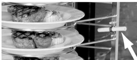
Por favor, no olvide introducir la sonda térmica en el tubo de cerámica del bastidor móvil portaplatos cuando el aparato la solicite.
