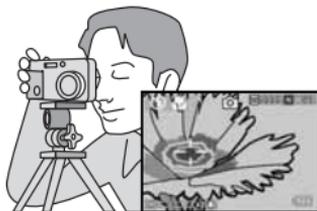
La función de desplazamiento de objeto AF le permite bloquear el foco para fotografía en macro solo por la operación de un botón sin mover la cámara. Esta función es útil para hacer tomas en un trípode.
