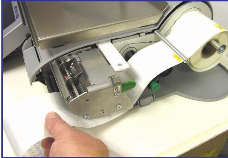
Instale el rollo de etiquetas en el carrete y quite aproximadamente 15 cm de etiquetas del revestimiento protector. Pase las etiquetas por debajo de las guías y de la cabeza de impresión como se muestra aquí.
