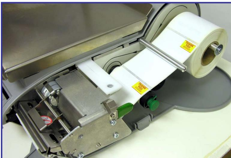
Impresora con las etiquetas instaladas correctamente.
