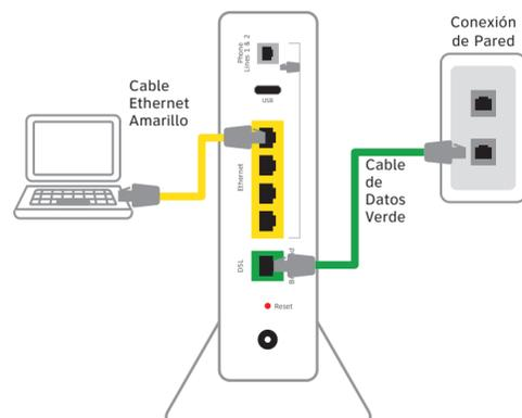
**C.** Retira el adhesivo que cubre el puerto "Power" (Energía). Conecta el Portal Wi-Fi a un enchufe eléctrico mediante el cable de corriente nuevo.
