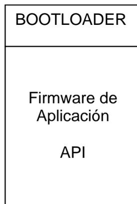
El Bootloader interactúa con el BOOTMANAGER, software que corre sobre una computadora, la cual habilita a los instaladores o personal de mantenimiento a ejecutar una actualización de firmware o proveer al equipo de la configuración inicial.
