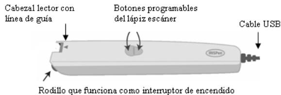
El IRISPen es un lápiz escáner que tiene el tamaño y la forma de un rotulador. Se conecta a un **puerto USB** de su ordenador y no requiere alimentación eléctrica externa. El IRISPen dispone de un **cabezal lector** y una línea de guía, un rodillo y dos botones programables.
