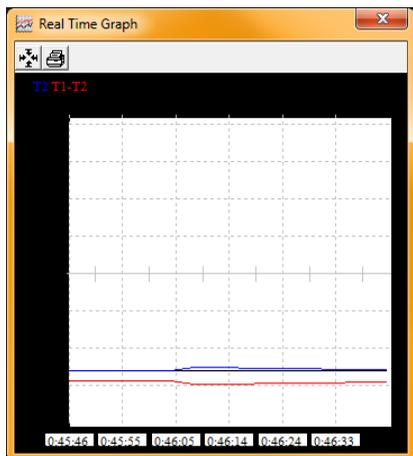
Haga clic en PRINT para obtener una impresión de la gráfica. Presione el icono de cuatro flechas (contiguo al icono PRINT) para cambiar la escala y seleccionar el rango de datos a ver. Vea el diagrama enseguida
